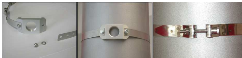
Obr. 2: vlevo: rozpjte upínací pásek, střed: umístěte destičku do požadovaného místa, vpravo: přitáhněte upínací šroub
